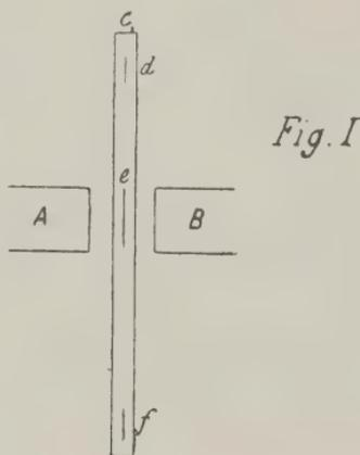
l'action d'un puissant électro-aimant, dont les pôles sont en A et B; *d* et *f* ne subissent qu'une faible action magnétique. Afin de maintenir autant que possible les trois bouteilles *d*, *e*, *f* à la même température et soustraire *e* à la chaleur dégagée par le courant électrique et le travail magnétique, on fait circuler dans *c* un fort courant d'eau de la ville : l'eau pénètre en *e* et sort en *f*; de plus, en *d* et *f* sont placés deux thermomètres de Beckman sur lesquels
